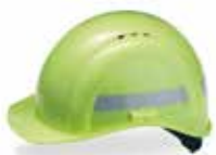
Color Amarillo alta visibilidad. De polietileno alta densidad. Cubierta del casco con leve inclinación hacia la nuca. Ranuras laterales para ajustar protectores auriculares. Canaleta para lluvia.
