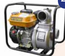
Motobomba aguas sucias AY 50 KT Caudal 30.000 L/H Altura máx. (presión) 30 m. (3 BAR)
